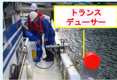
送受波機の船舷への取付状況
