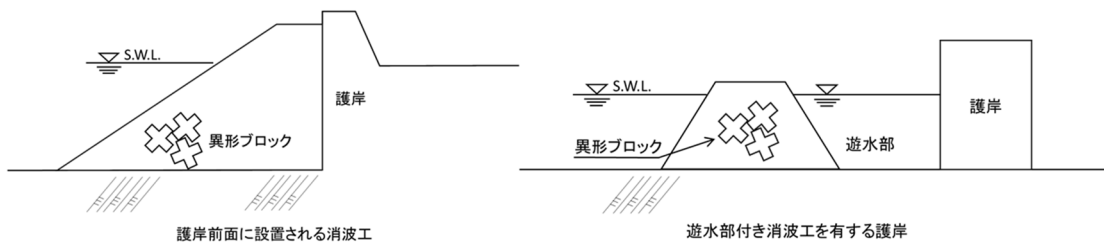
図-1.1 消波工の模式図
